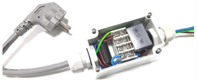
1.5SQ 전선을 이용한 블로킹 필터 사진
